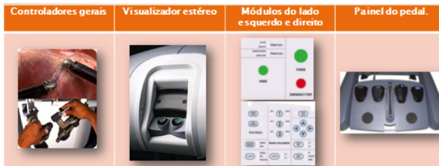
Figura 5 – Subsistemas constituintes do console do cirurgião
